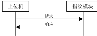
图 3 请求/响应示意图
